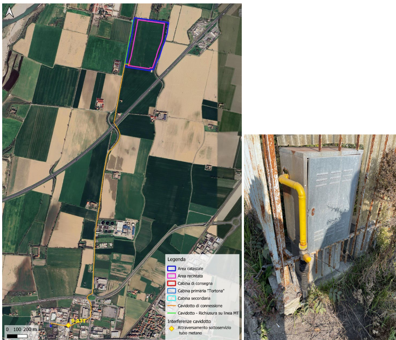
Figura 11. Contatore Gas metano, posto nelle vicinanze della Cabina Primaria "Tortona" e individuato nell'immagine con un segnalino giallo.
